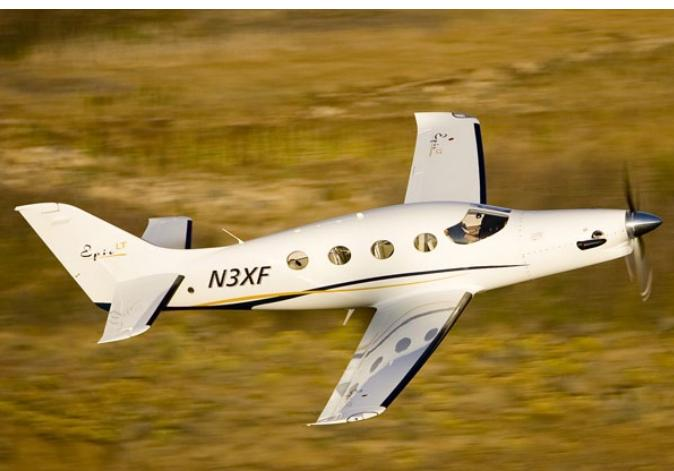
Основной моделью компании является шестиместный турбовинтовой самолет Epic LT. Он оснащен двигателями Pratt & Whitney PT6-67A. Скорость полета самолета составляет около 630 км/ч., а дальность — до 3470 км. Стоимость самолета в зависимости от комплектации варьируется от \$2,1 млн. до \$5 млн. Готовые самолеты по заказу клиентов собираются на авиазаводе в Орегоне.
