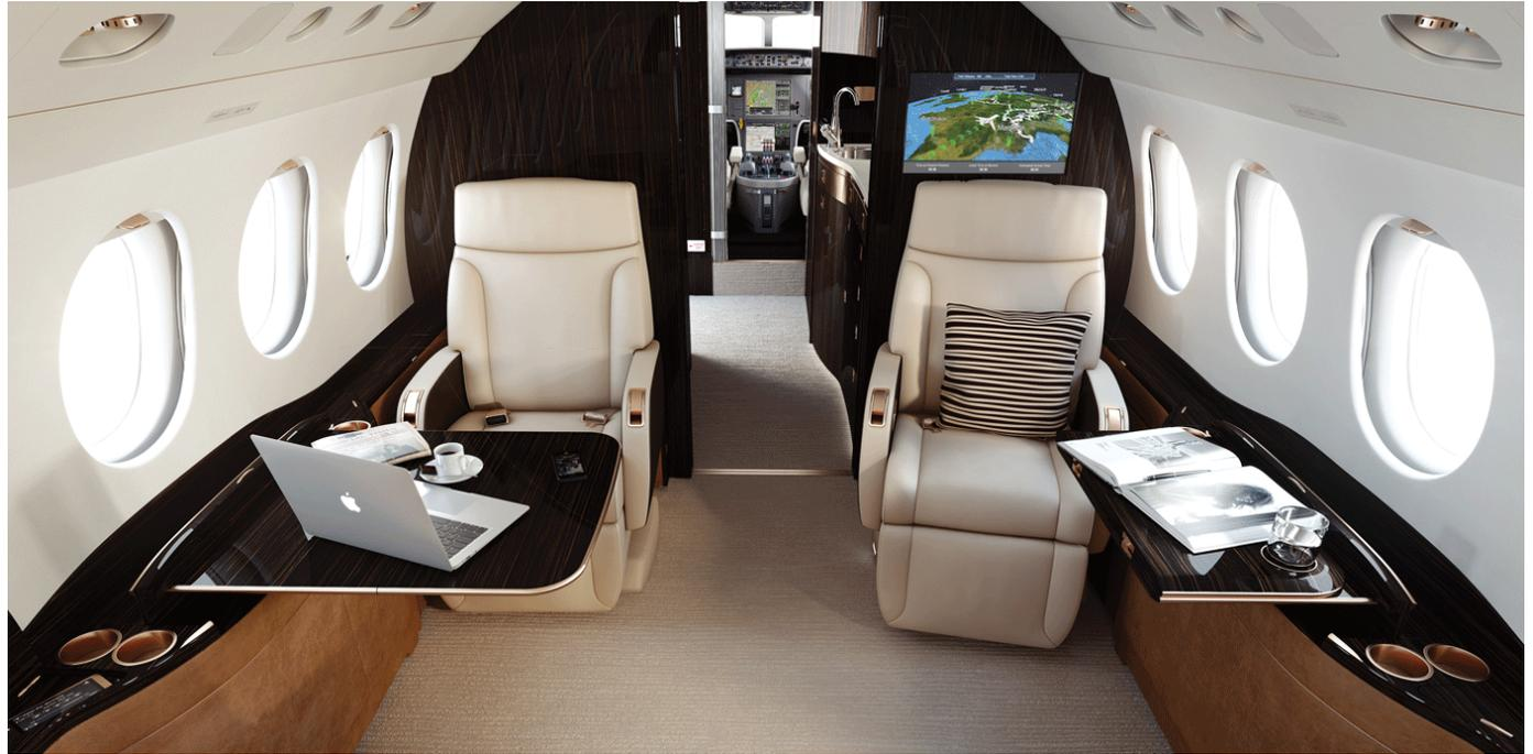
минаторов (в стандарте 32 по 16 с каждой стороны), в том числе четыре в камбузе и зоне отдыха экипажа. Окно в туалете может быть оснащено электрохромной системой затемнения. Отношение площади иллюминаторов в пассажирском салоне составляет 0,16 и равно таковому в G650.
