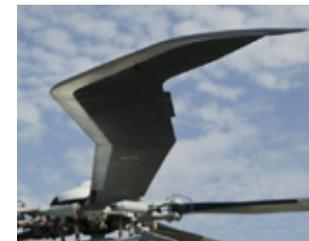
Во-первых, сделать вертолеты тише можно благодаря использованию лопастей несущего винта Blue Edge, кардинально отличающихся от привычных по форме и конструкции. Лопастя Blue Edge уже прошли тестовые испытания с использованием вертолетов EC155. Как оказалось, результаты превзошли все ожидания.
