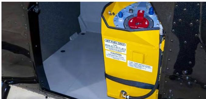
Бак вмещает 88 литров, тем самым, увеличивая дальность полета на 185 км или 1 час летного времени. Он устанавливается на специальный стеклопластиковый поддон в багажном отделении вертолета и занимает одну треть пространства. Дополнительный топливный бак и поддон можно убрать из багажного отделения при необходимости.
