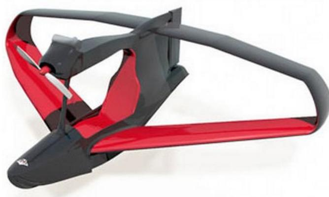
Этот весьма небольшой вес летательного средства передвижения достигается за счет максимально облегченной конструкции корпуса, сделанного целиком из углеродного композитного волокна. Конечно, на таком самолете не летаешь в грозу или просто при сильном боковом ветре. Так что ближайшим его аналогом среди наземных транспортных средств можно назвать велосипед или мопед.
