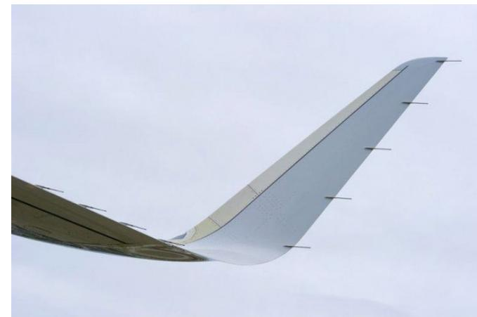
прежде чем принять окончательное решение об оснащении крыла A320 законцовками типа Sharklets, поскольку основной эффект от законцовок проявляется на крейсерских режимах полета, а законцовки длиной 2,5 м утяжеляют самолет (требуется еще усиление конструкции крыла).
