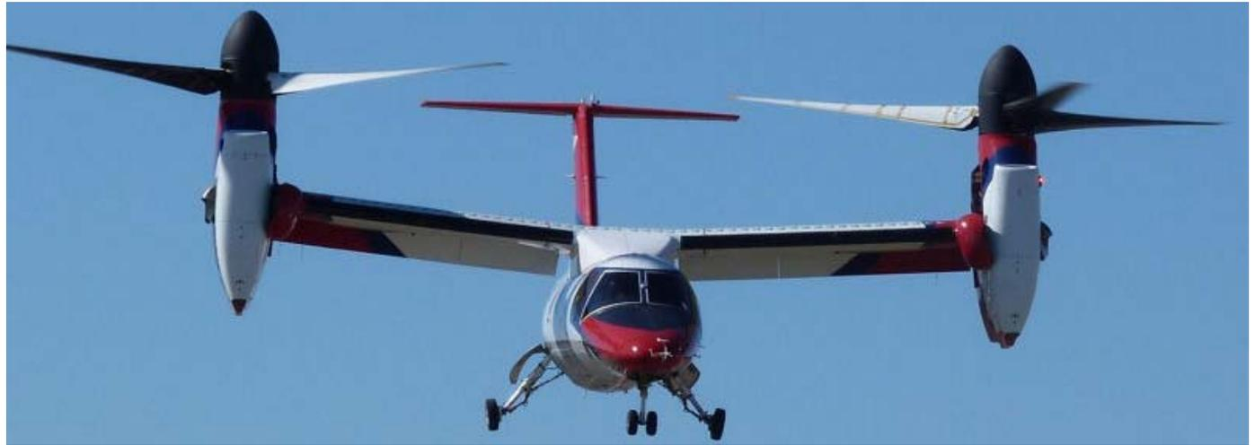
иметь крейсерскую скорость 275 узлов (510 км/ч) и потолок в 25000 футов (7620 м), что выходит далеко за пределы обычного рабочего диапазона вертолета.
