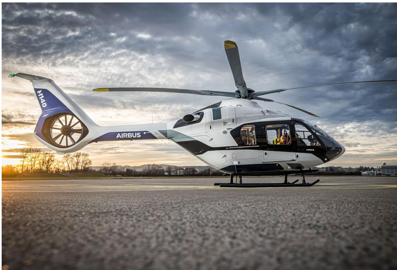
H140, оснащенный двигателями Safran Arrius 2E мощностью 700 л.с., обладает лучшей грузоподъемностью и дальностью полета в своем классе. Управление двумя двигателями вертолета осуществляется с помощью двухканальной цифровой системы управления двигателем (FADEC), гарантирующей беспрецедентный уровень производительности всех двигателей (AEO) и значительный запас мощности при нерабочем одном двигателе (OEI).
